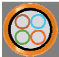
Εικόνα 9: Ενδεικτική τομή πολυσωλήνιου άμεσης ταφής τεσσάρων μικροσωληνίσκων
