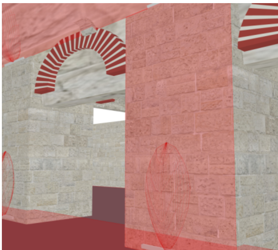
Εικόνα Β.2.13.β Ενδεικτική τοποθέτηση του γραμμικών φωτιστικών στη βάση των πεσσών (φωτισμός κορμού)
