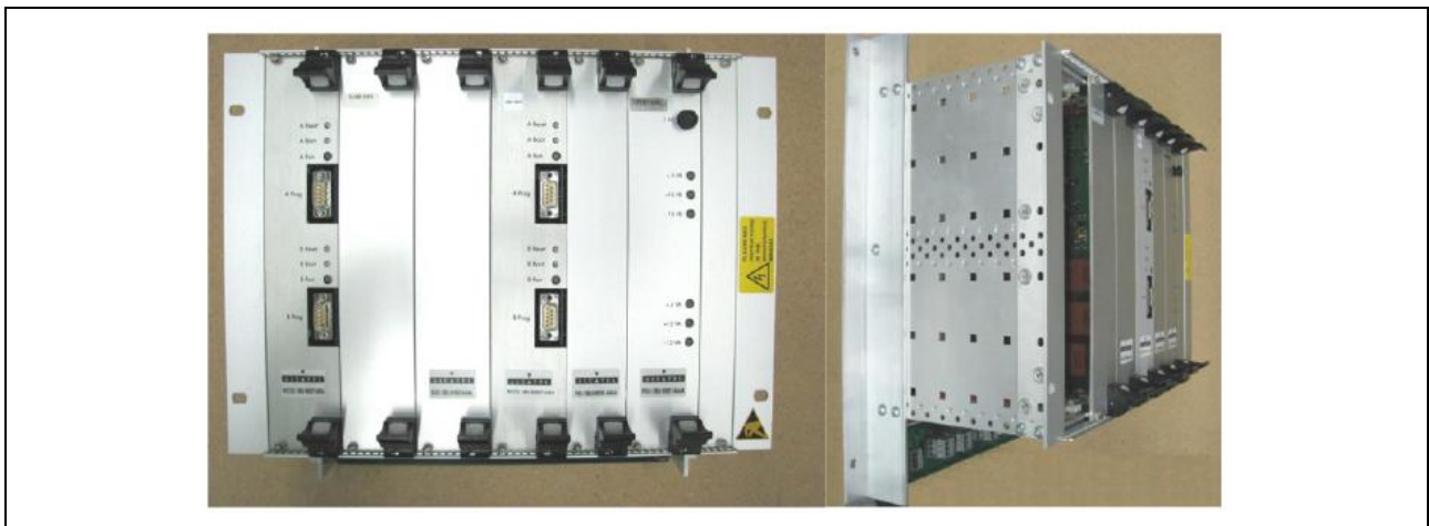
Εικόνα 165: Τοποθετημένα Στοιχεία Εξοπλισμού Ηλεκτρονικής Μονάδας (LEU)
