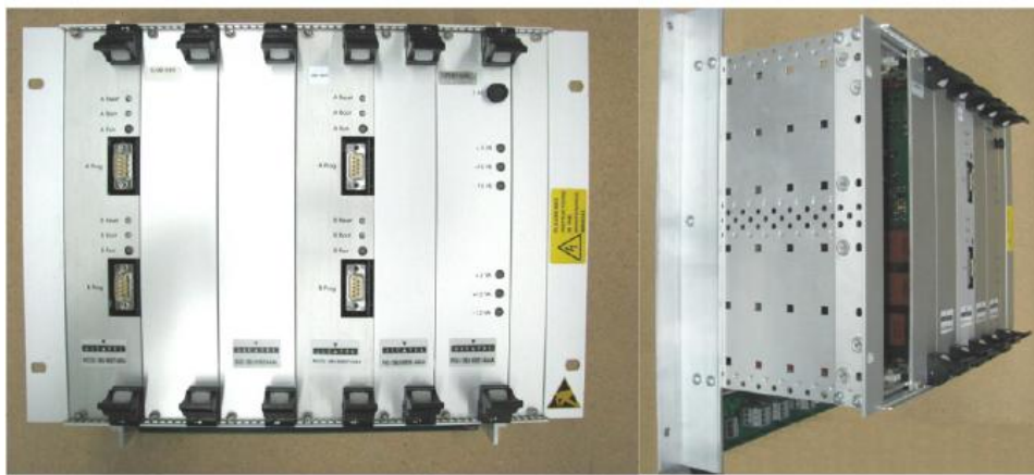
Εικόνα 30: Τοποθετημένα Στοιχεία Εξοπλισμού Ηλεκτρονικής Μονάδας (LEU)
