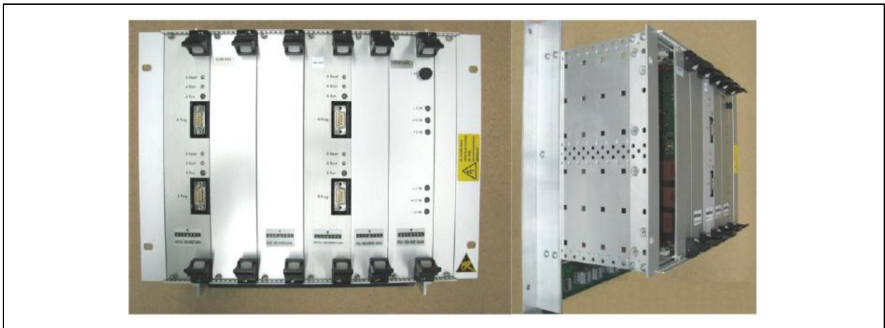
Εικόνα 215: Τοποθετημένα Στοιχεία Εξοπλισμού Ηλεκτρονικής Μονάδας (LEU)
