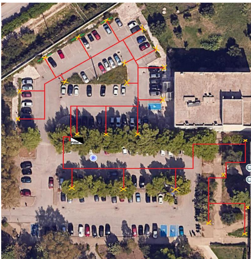
Εικόνα 1. Οδεύσεις νέας καλωδίωσης ιστών φωτισμού parking Κτιρίων Τμ. Φυσικής.
