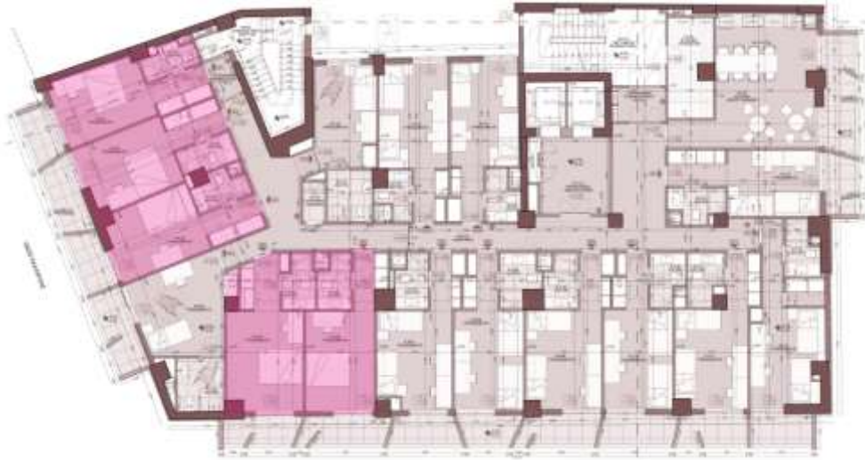
Εικόνα 5: Κάτοψη ΣΤ' ορόφου (ροζ: τύπος μονόκλινου δωματίου)
