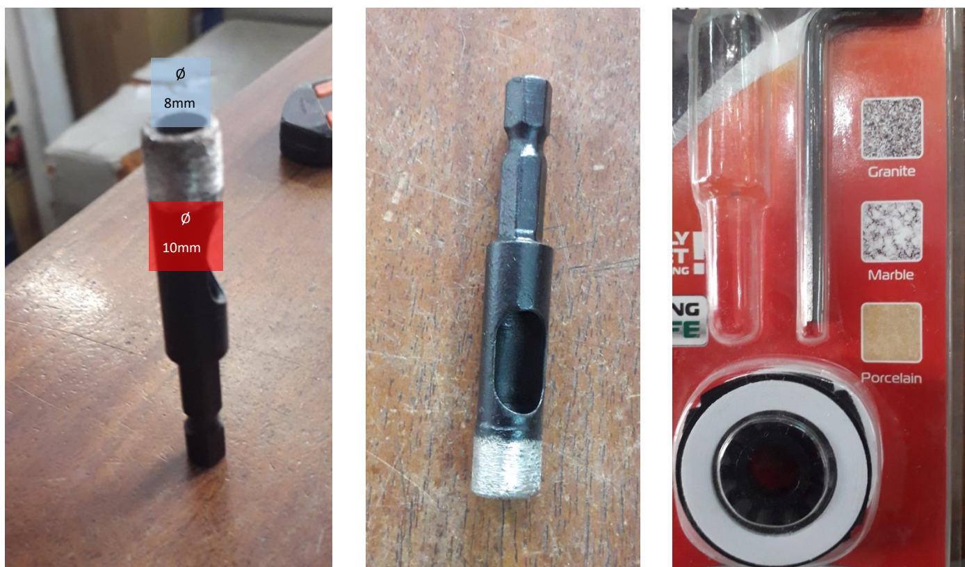
Εικ.18-20 Κεφαλή τρυπανιού που αφαιρεί κυκλικό τεμάχιο από σκληρά υλικά
