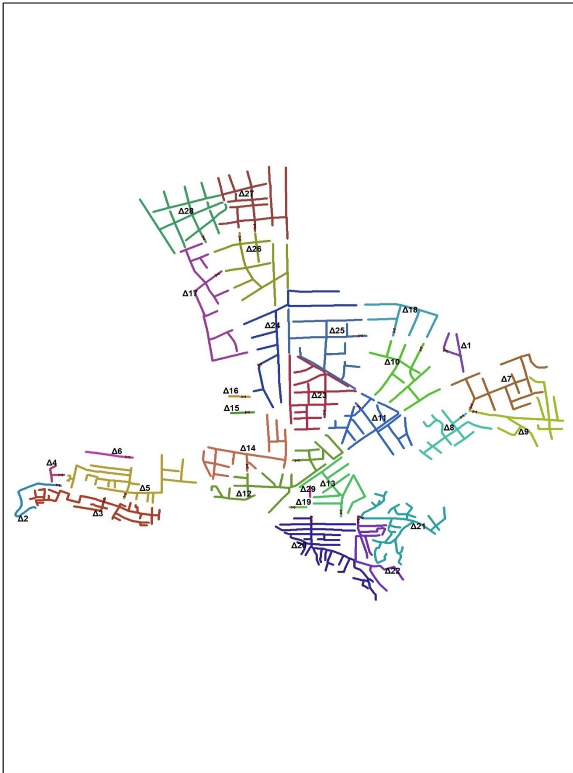
Διάγραμμα 3.2.2. Διάταξη ανάπτυξης δικτύου χαμηλής πίεσης Φ63 πύκνωσης δεντρικής μορφής του Ναυπλίου.
