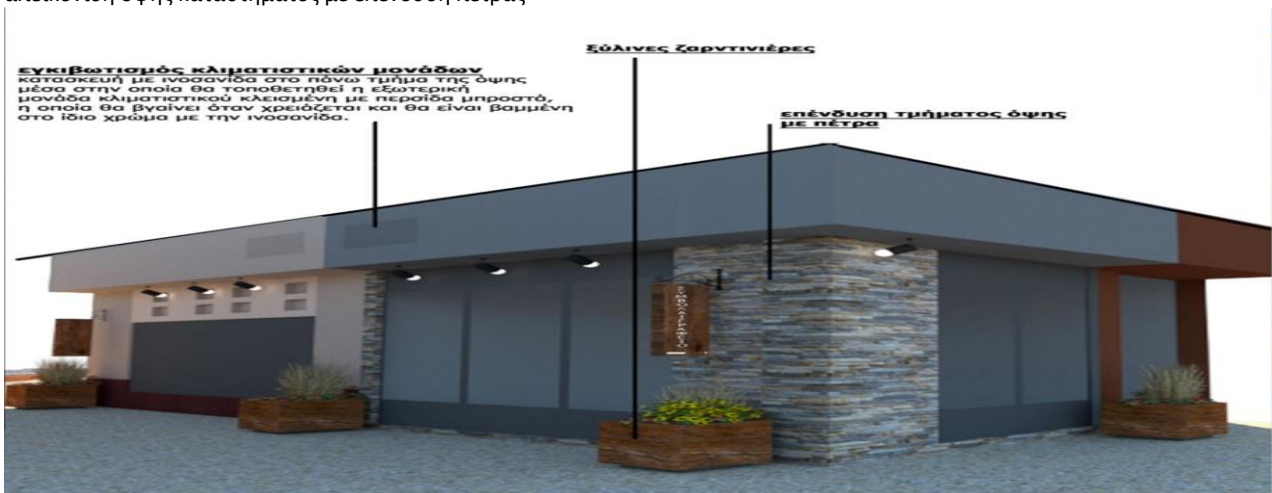
Εργασίες επένδυσης με πέτρα (προμήθεια και τοποθέτηση πέτρας): 100τ.μ.
